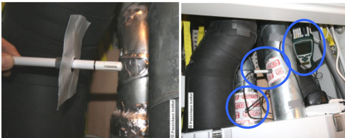
Abbildung 74: Temperatur-Feuchte-Sensoren vor dem Einbau mit Manschette zum luftdichten Einbau im Lüftungsrohr (Bild links). Montierte Kombisensoren und Datenlogger über dem Lüftungsgerät einer Wohnung (Bild rechts).
