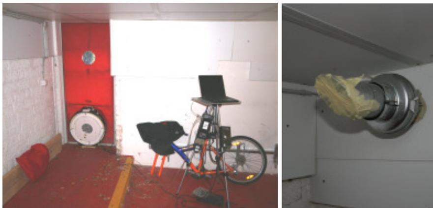
**Abbildung 85:** In der Kellerausgangstür montierte Blower Door (Haus 50) (links) und für die Messung abgeklebter Abluftventilator (rechts).
