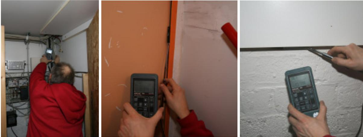
Abbildung 86: Leckagensuche während der Blower Door Messung im Keller von Haus 50. Fotos von nennenswerten Leckagen von links nach rechts: Kabelschacht zum Nachbarkeller, Kellertür zum Treppenhaus und Außenwand Anschluss der Begleitdämmung.
