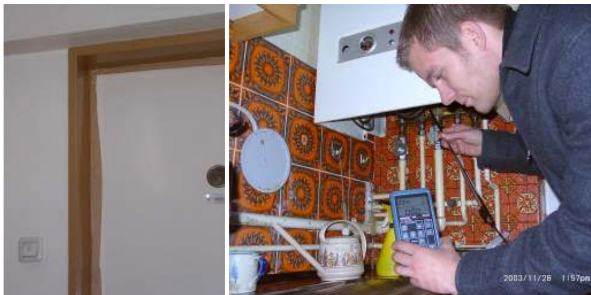
Abbildung 25: Temporär abgeklebte Wohnungstür und Kontrolle der Lüftströmung an der Gastherme mittels Thermoanemometer.
