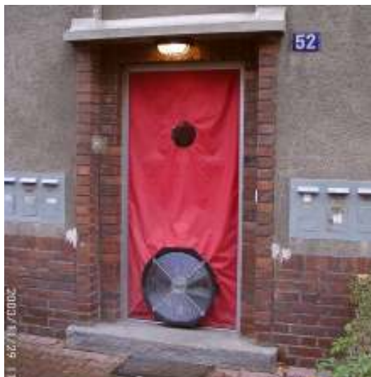
Abbildung 24: Eingebaute Blower Door in der Hauseingangstür und geöffnete Wohnungstüren während der Messung.
