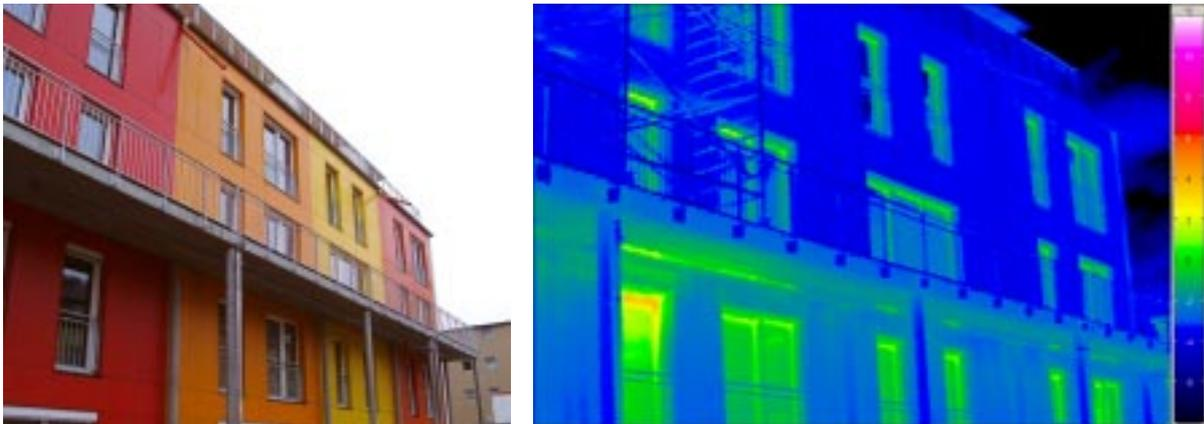
**Abbildung 34:** Nordfassade oben von Haus B. Das eben noch offene Fenster ist wieder geschlossen, eine leichte Temperaturfahne am Balkon darüber ist noch erkennbar.
