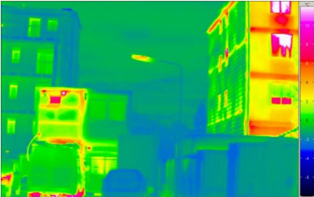
Abbildung 27: Links Haus B des gut gedämmten Passivhauses (mit Außenwandoberflächen um  $-2\text{ °C}$  (blau), Fensteroberflächen um  $0\text{ °C}$ ), rechts eine konventionelle Außenwand des Hospitals mit Wandoberflächentemperaturen bis  $6\text{ °C}$  und Fensteroberflächen über  $12\text{ °C}$ .
