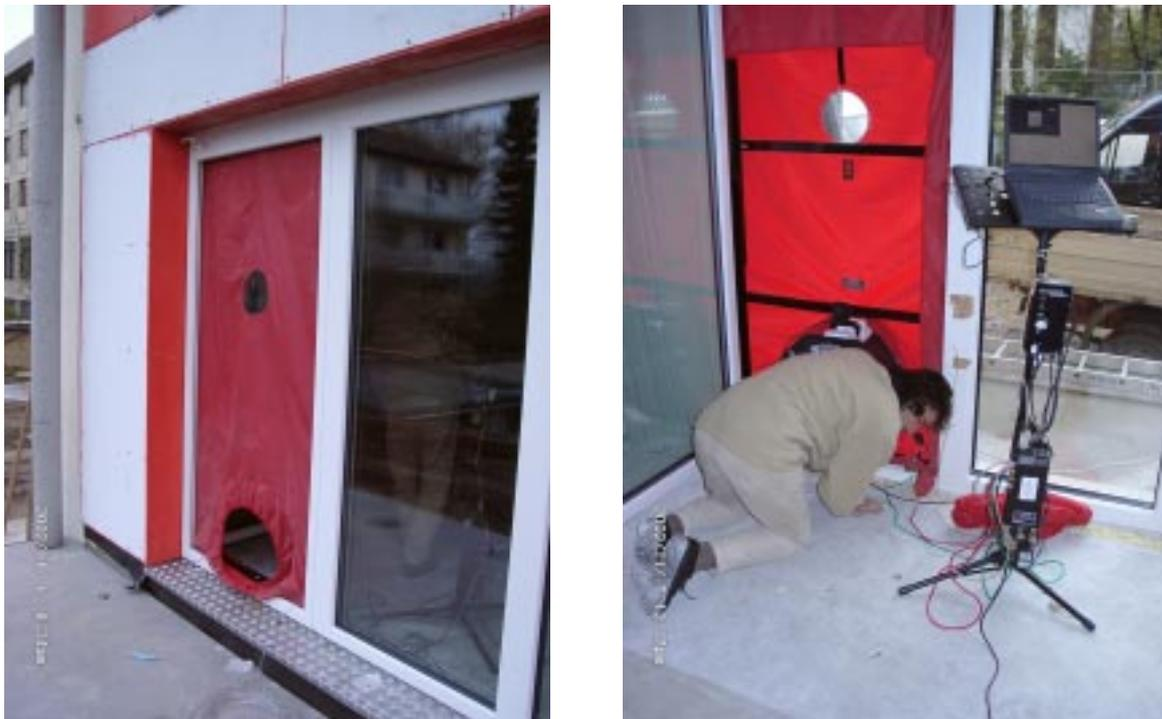
Abbildung 17: Eingebaute Blower Door in die Terrassentüren von zwei unterschiedlichen Wohnungen. Im linken Bild die Sicht von Außen mit noch fehlendem Gebläse und im rechten Bild die Sicht von innen während des Einbaues des Gebläses.
