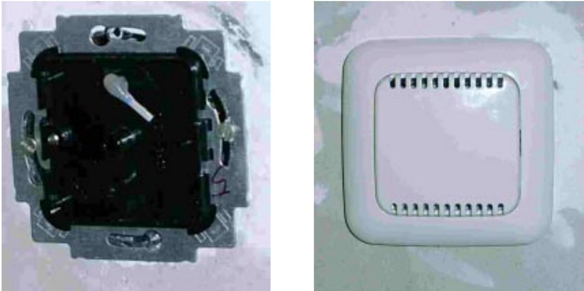
**Abbildung 57: M-Bus-Temperatursensor mit Pt 100 Widerstand mit und ohne Deckel und Blende.**
