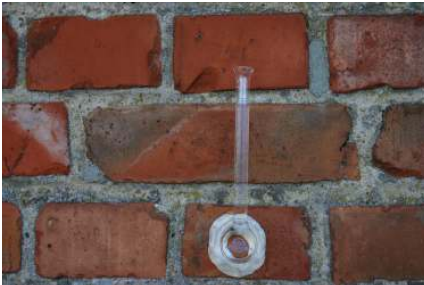
Äußere Wandoberfläche, orientierende Stichprobenuntersuchung Hydrophobierung mit Prüfröhrchen nach Karsten
