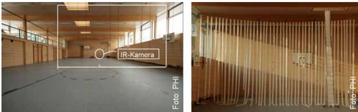
Abbildung 89: Messaufbau in der Passivhaus-Sporthalle. Zur Visualisierung der Lufttemperatur im Hallenschnitt wurden Papierstreifen in der Halle aufgehängt und thermographiert. In der Ebene der Papierstreifen wurden zusätzlich Temperatursensoren aufgehängt.
