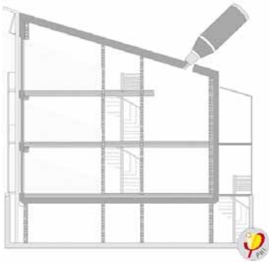
Abbildung 6: Stiftregel: Die wärmedämmende und die luftdichte Gebäudehülle sollten im Gebäudeschnitt möglichst ohne abzusetzen mit einem Stift eingezeichnet werden können. (Quelle: PHI)
